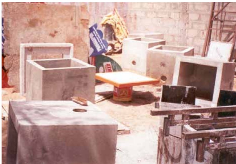
Figure 13.20 : Nouvelle génération de regards de visite.
